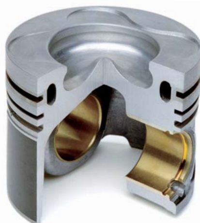
Kolben mit gekühltem Ringträger
