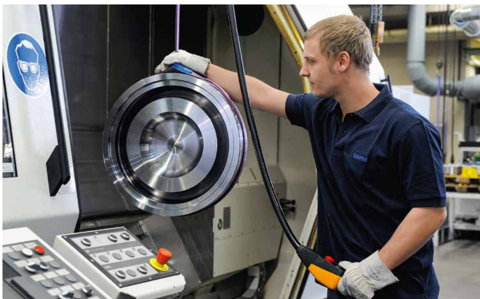
Mitarbeiter am Dreh-Fräszentrum bei der Produktion eines Großkolbens.
